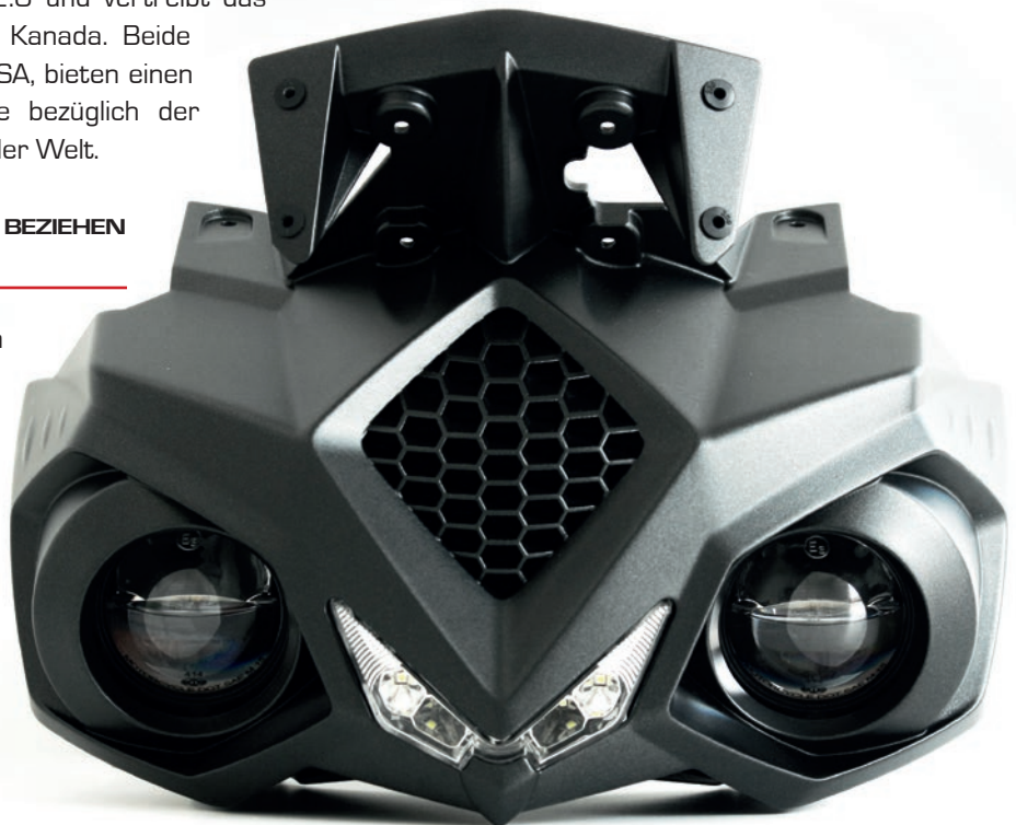
Frontabdeckung von Energica Eva, im 3D-Druckverfahren für die Vorserie gefertigt
