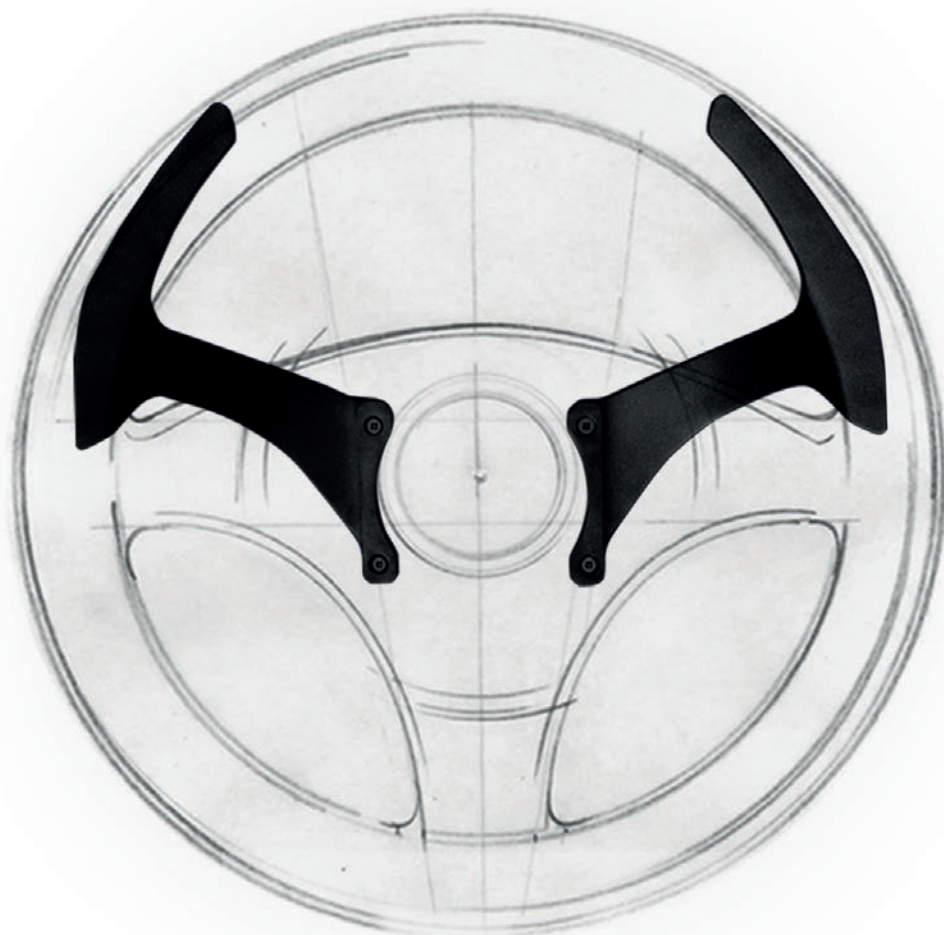
Gangschaltungshebel am Lenkrad im 3D-Druckverfahren
